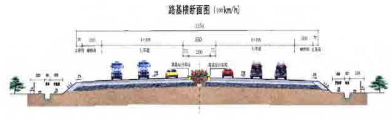
图 2.4-1 主线路基横断面图（路基宽 33.5m）
